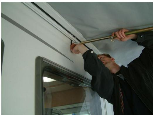
Die rechten und linken Seitenwinkel mit den dazugehörigen Stangen werden auf die gleiche Art errichtet, durch das Einfügen der Querverbindungen und das entsprechende „Auf-Höhe bringen“ und „Ausspannen“ stabilisiert sich das Gerüst Schritt um Schritt.
